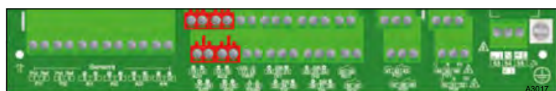
Fig. 33: 4 ... 20 mA output connectors (AO1 ... AO4)
