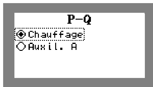
Figure 67. Configuration de la sortie P-Q en mode chauffage
