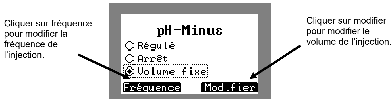
Figure 56. réglage du volume et de la fréquence d'injection
