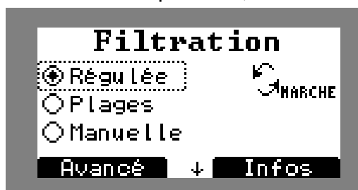
Figure 49. Sélection du mode régulé
