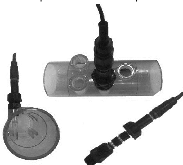
Figure 17. montage des portes-sondes et de la sonde Redox
