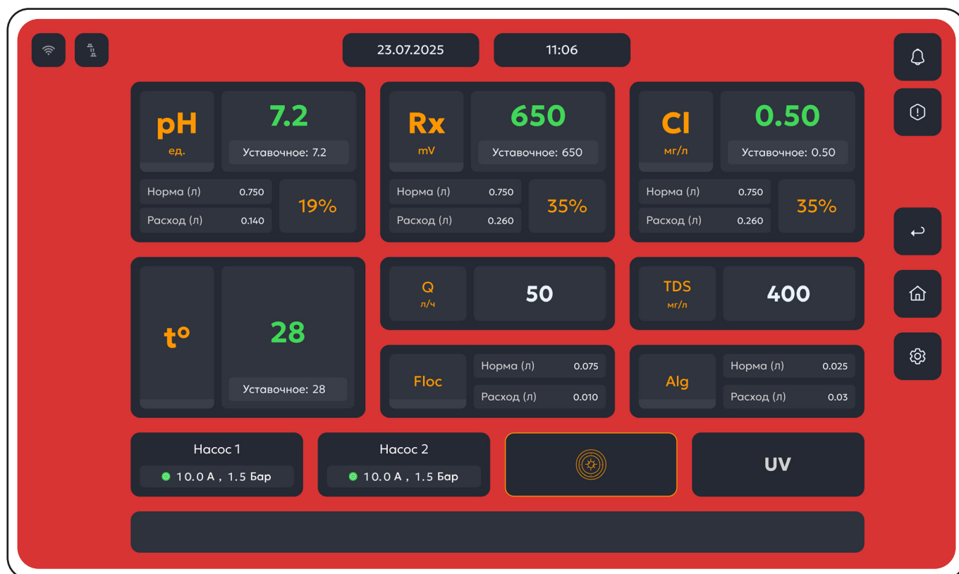
Рисунок 12. Главный экран при возникновении аварийной ситуации.
