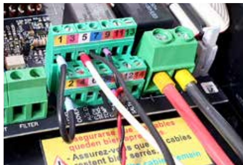
Connexion du capteur de débit (programmé par défaut).
