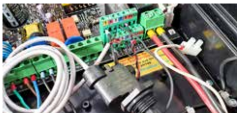
Connexion du capteur de débit (programmé par défaut).
