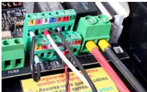
Connexion avec le capteur de débit de la cellule (effet pile), sans capteur de débit
