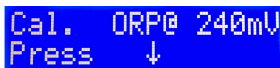
Figure 12 - Insertion de la sonde ORP dans le standard 240mV
