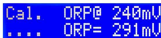
Figure 13 - Étalonnage ORP standard 240 mV
