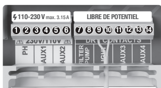
LIGHT Commande éclairage 9 et 10
