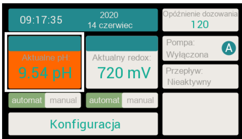
Rys.2 – przekroczony alarm górny pH
